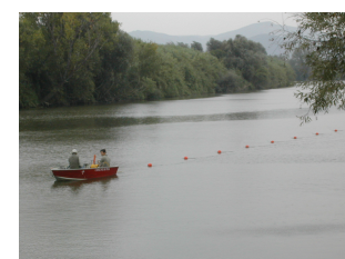
Rilievo geoelettrico con elettrodi galleggianti
