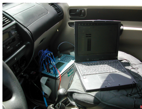
Resistivimetro a 10 canali
