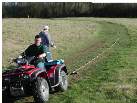
Profili geoelettrici in continuo mediante QUAD (Gentile concessione IRIS INSTRUMENTS)
